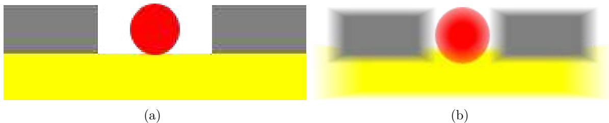
Abbildung 4.22: Veranschaulichung, wie der Mikroplasma-Kanal mit Entladung (a) beim Blick von der Seite in den Kanal auf dem CCD-Chip abgebildet wird (b). Der rote Kreis symbolisiert das von der Entladung emittierte Licht, in Grau sind die beiden Nickelelektroden dargestellt und in Gelb das Dielektrikum.
