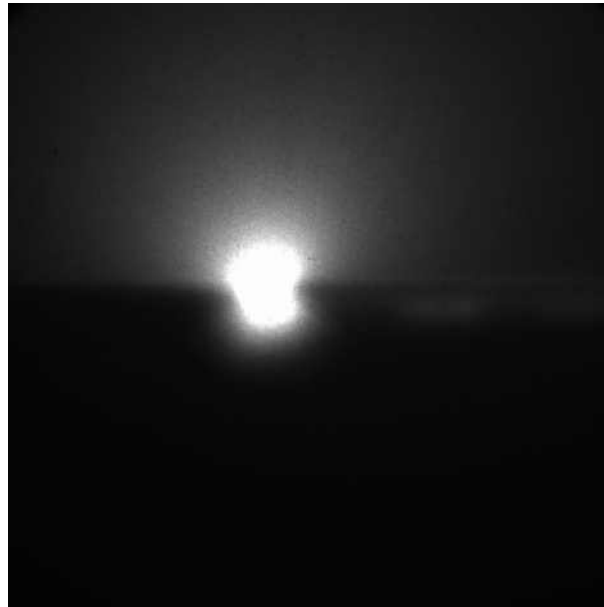
Abbildung 4.21: Darstellung des Bildes, aus dem Abbildung 4.20 entstanden ist, in Graustufen. Hier ist das gesamte 1024 x 1024 Pixel (entspricht etwa 2,2 mm x 2,2 mm) große Bild dargestellt. Die Oberkanten der beiden Nickelelektroden sind deutlich zu erkennen.
