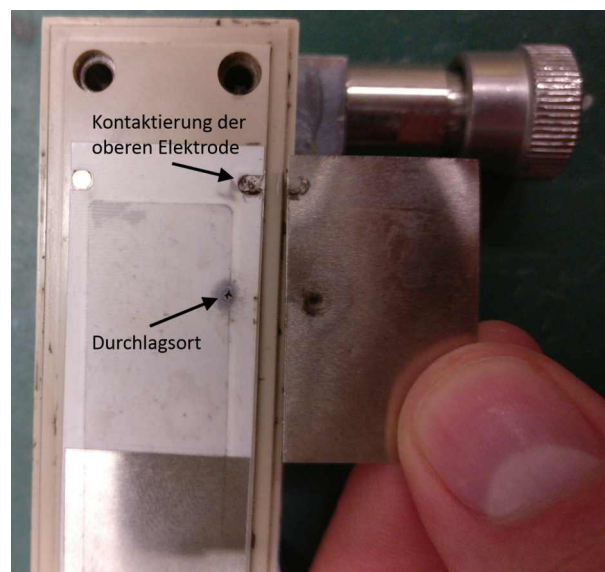
Abbildung 3.3: Nach etwa vier Monaten zerstörtes Dielektrikum (Kanal 1). Der Rand des Magneten ist durch das Dielektrikum hindurch zu erkennen.
